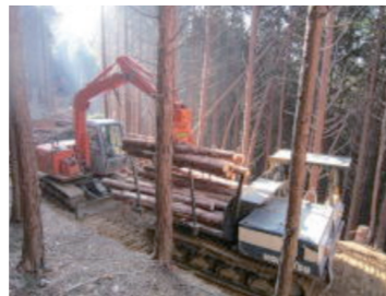
運搬車への積み込み作業
