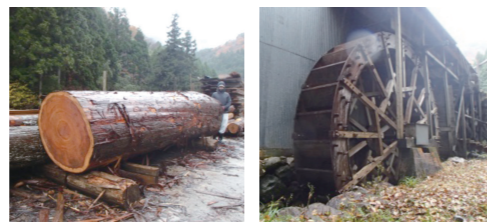
スギ末口90cm、長さ4.7m 製材用水車
