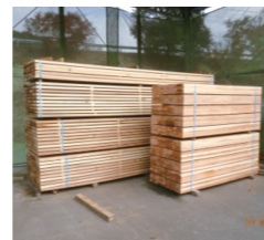
足場板・矢板
